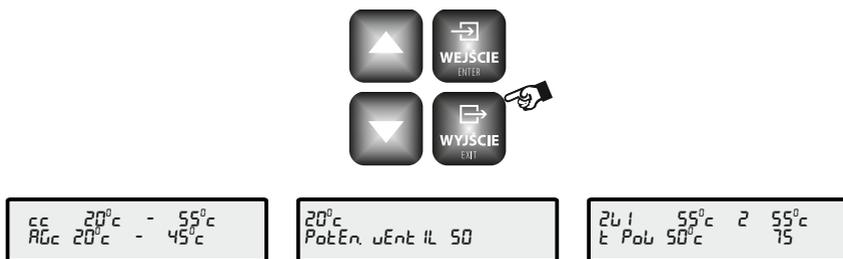
**CAMBIO DE TEMPERATURA CC** - Pulsar botón ( $\Delta$ ), en la pantalla parpadeará la temperatura CC. Elegir la temperatura adecuada ( $\Delta$ ), ( $\nabla$ ), guardar pulsando botón (ENTER).
