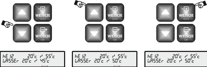
**SOMMERBETRIEB** - Drücken Sie Taste (△), auf dem Display blinkt die Temperatur für ZENTRALHEIZUNG. Drücken Sie Taste (▽) und halten Sie eine Weile bis es auf dem Display statt Temperatur waagerechte Streiche angezeigt werden. Bestätigen Sie, indem Sie Taste (EINGANG) drücken.
